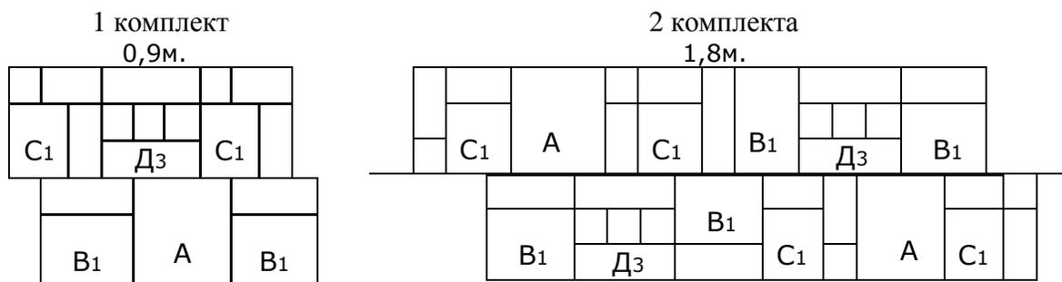
Надпись «A=1» внутри рисунка означает, что в одном комплекте содержится 1 блок «А», «B=2»- означает, что в одном комплекте содержится 2 блока «B» и т.д.
