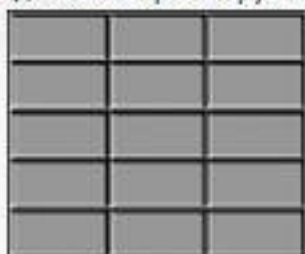
Линейная укладка клинкерной брусчатки со сдвигом
