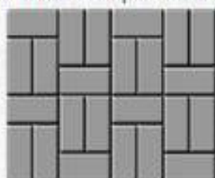
Модульная укладка с линейной перевязкой клинкерной брусчатки
