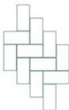
Елочка (паркетная укладка)
