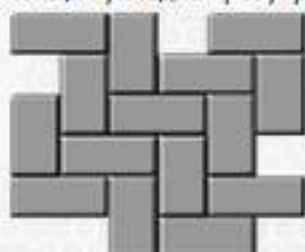
Спиральная укладка тротуарного кирпича
