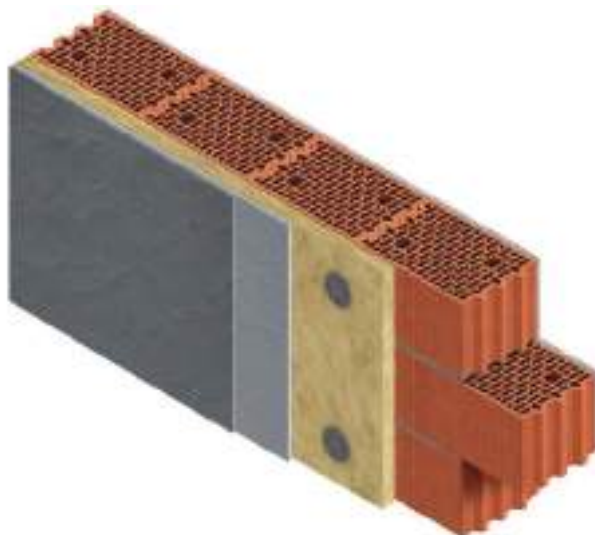
Рис. 3. Конструкция стены из блоков Porotherm 25, минераловатных плит и штукатурки
